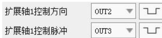
输出口 OUT2（管脚 13）控制旋转轴旋转方向；
